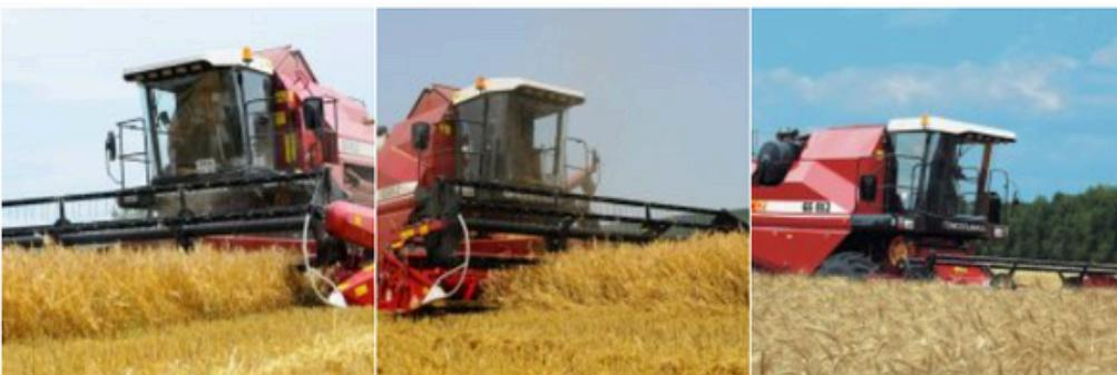
A colheitadeira GS812 é uma máquina clássica de classe média com um cilindro debulhador de 1.200 mm de largura e um stripper de quatro andadores. O esquema tecnológico seguro e os baixos custos operacionais tornam a máquina GS812 uma solução ideal para empresas agrícolas de médio porte.
